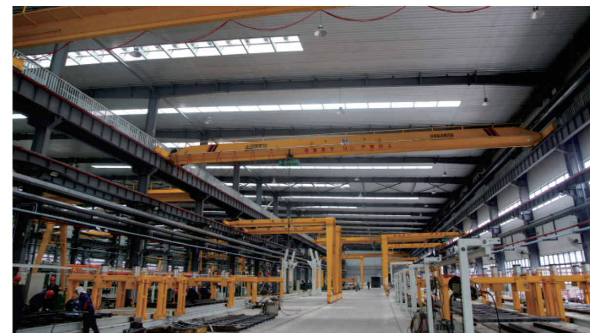
结构焊接生产线
